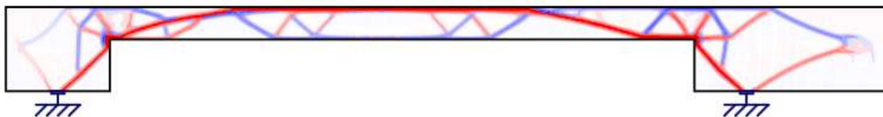
Topologická optimalizace – hledání tlakových a tahových diagonál
